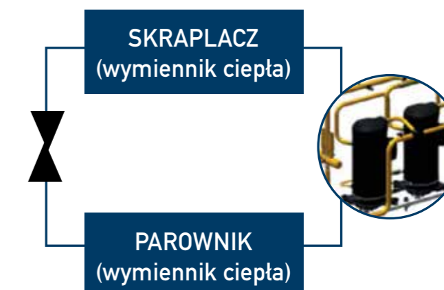
Rysunek 18: Elementy obiegu czynnika chłodniczego ©Carrier
