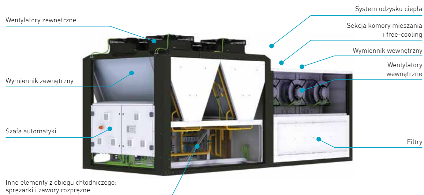
Rysunek 17: Elementy składowe jednostki Rooftop ©Carrier
